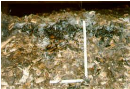
Abb. 33: Kondensationsband im Bereich der Schüttungskrone
