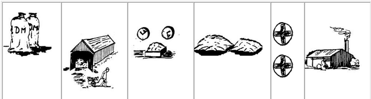
Abb. 24: "Belüftungskühlung" - monetärer und technischer Aufwand, Trocknungsdauer, Trockensubstanzabbau, Sporenbildung sowie Anlagengröße
